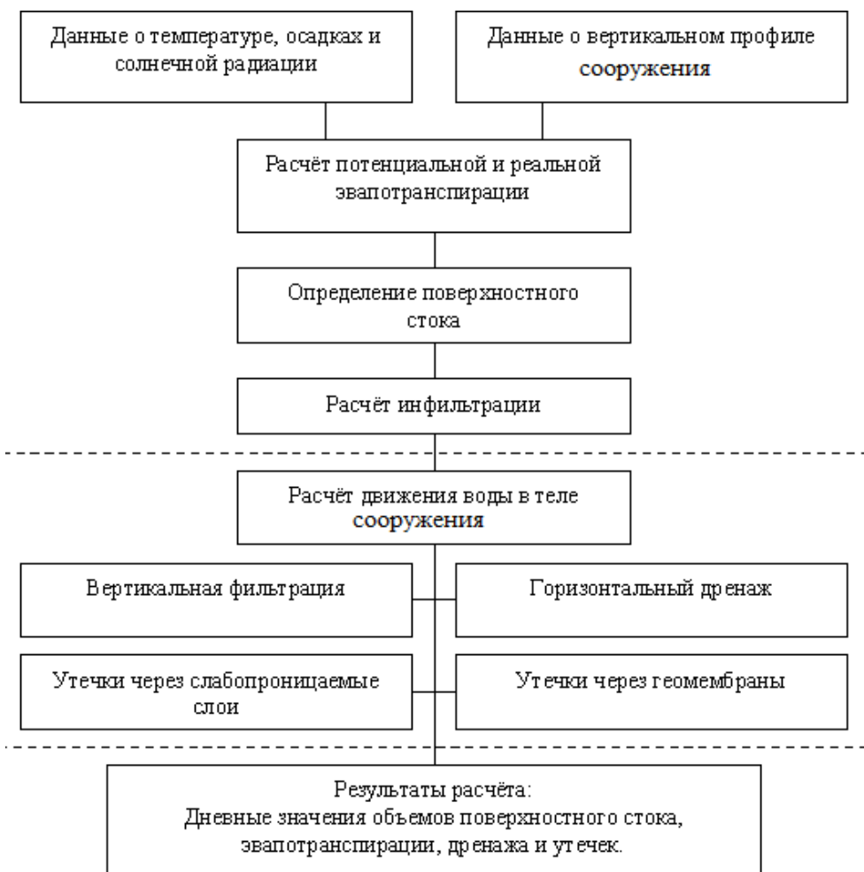
Рис. 4.6. Блок- схема расчёта водного баланса сооружения
